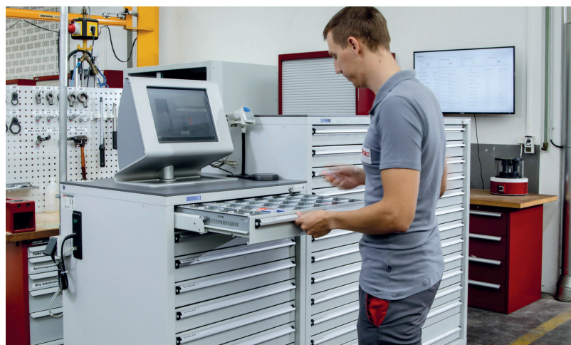
1 Vernetzbare Werkzeug-Ausgabeschränke sind eine zentrale Komponente von I4.0-Toolmanagement-Systemen. Aus ihnen werden Halter sowie Reduzierungen und/oder Verlängerungen der Werkzeuge nach digitalem Werkzeugplan genommen, bevor man sie nach 3D-Modellen montiert © Diebold
